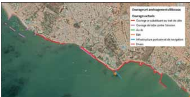
Figure 25 : Exemple de relevés de classes d'ouvrages et d'aménagements littoraux sur une portion du littoral sénégalais (Commune de Saly, Thiès)
