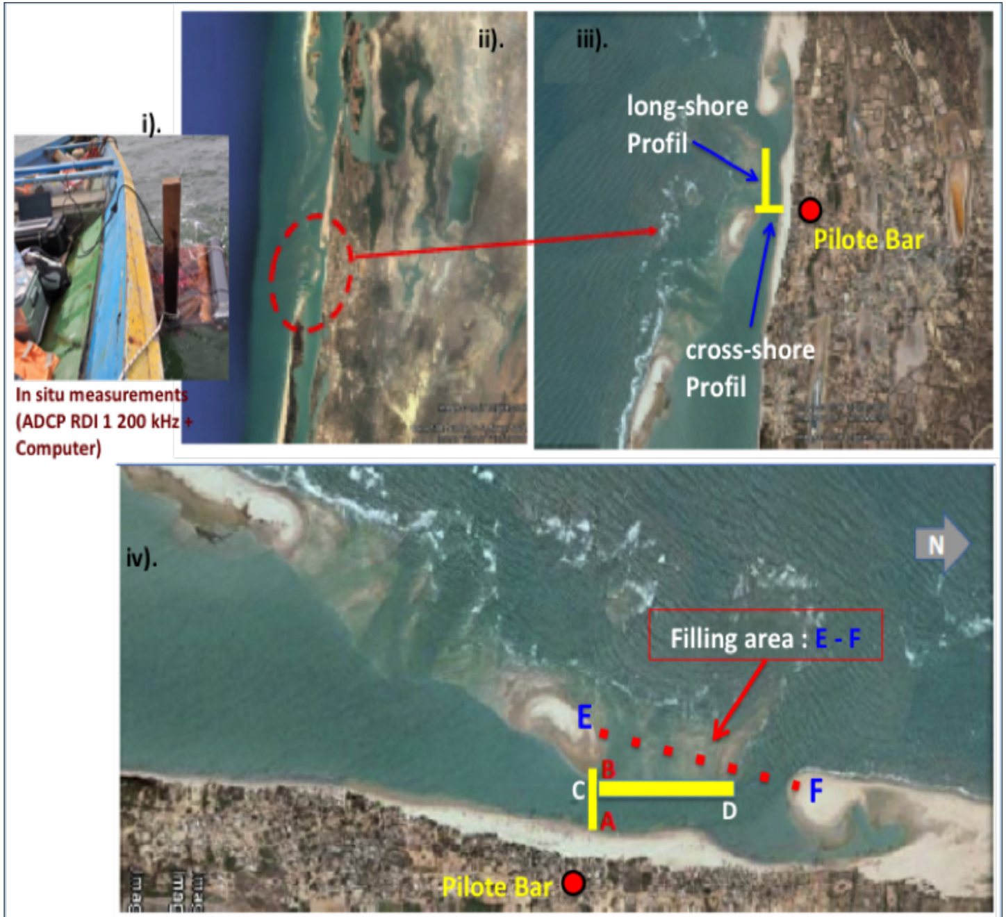
Figure 2. Dispositif de mesures des paramètres hydrodynamiques sur le littoral de Pilote Bar en Juillet 2017. i). ADCP embarqué au bord d'une pirogue ; ii). Une vue à l'échelle de la brèche de Saint-Louis ; iii). Une vue à l'échelle de la lagune de Pilote Bar en cours de formation et iv). Un zoom sur les segments de mesures de la marée : hauteurs d'eau et vitesses de courants.
